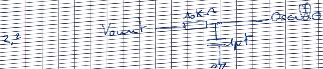
Le filtre passe bas permet d'enlever les vibrations des différents éléments électriques on a un  $T_a = 0,015$  et une  $f_c = 16 \text{ Hz}$
